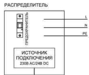
Для стандартного подключения достаточно 1 термостат, 1 регулятор и 1 источник напряжения для 1 жилого помещения.
